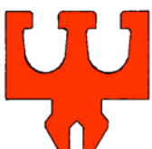
Anpassbares Profil TYPE I (40 x 25,5 mm)
